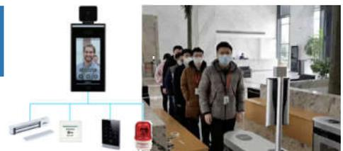
タブレットにカメラ・サーモセンサー・人工知能(AI)が搭載されており、1.5m範囲内の体温を高速自動判定します。
